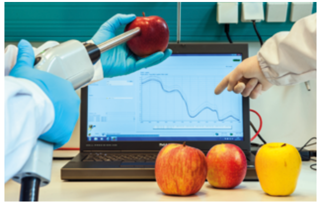
Abbildung 45: Die optische Nahinfrarot-Spektroskopie (NIRS): eine Technik für die nicht-destruktive Qualitätsanalyse.
