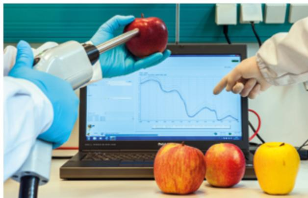
**Figura 45:** La spettroscopia ottica nel vicino infrarosso (NIRS): una tecnica per l'analisi qualitativa non distruttiva.
